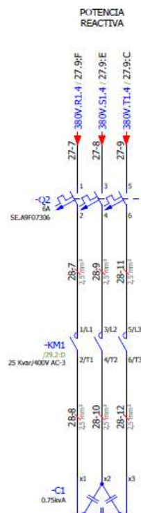
Figura 1- Contactor KM1 para control de reactiva (plano 28)
